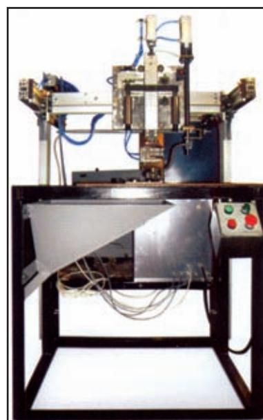
заданным координатам. Блок управления обеспечивает необходимый цикл работы в автоматическом режиме: подачу арматурного стержня до пластины, включение источника сварочного тока и его отключение после зажигания дуги, перемещения стержня вверх и его опускание под сварочным током в расплавленный металл, отключение источника сварочного тока. Выключение процесса сварки осуществляется автоматически.
