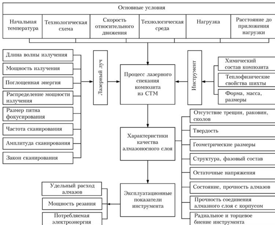
Рис. 2. Схема причинно-следственных связей между основными факторами и параметрами процесса лазерного спекания инструментального композита
