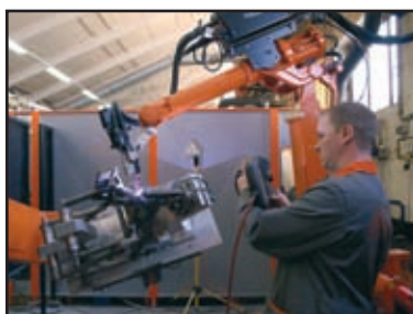
Автоматизированная ТИГ сварка с холодной подачей проволоки при изготовлении рамы мотоцикла RC8
