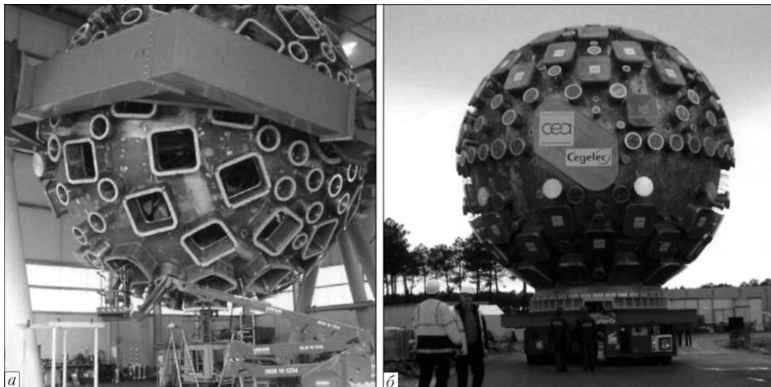
Рис. 4. Сварная сферическая камера «Laser Megajoule» для комплекса термоядерных исследований: а — процесс сварки и контроля в цеху; б — камера подготовлена к транспортировке
