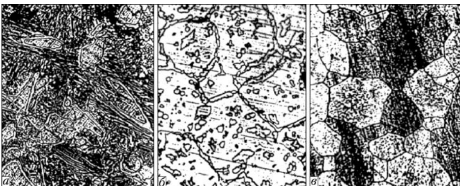
Рис. 3. Микроструктура припоя П21 на основе системы медь–цинк–олово в литом состоянии, \times 200 (а); горячепрессованном, \times 800 (б) и после высокоскоростного затвердевания расплава, \times 800 (в)
