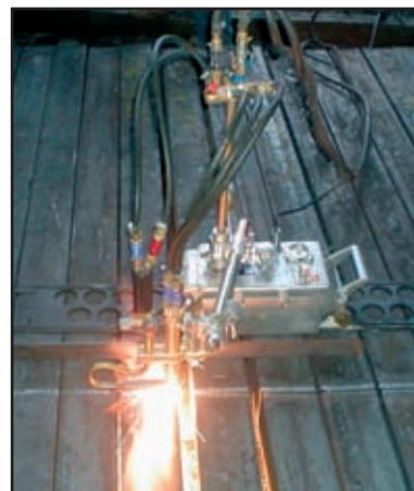
скорость газовой резки устройства может составлять от 80 до 800 м/мин.
