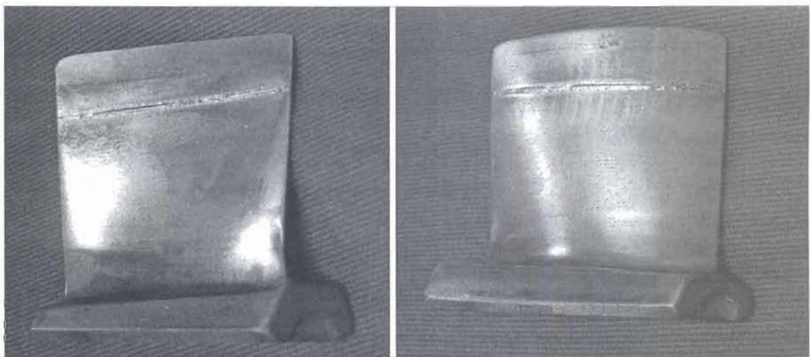
Рис. 2. Общий вид лопатки с ремонтным швом: а — лицевая сторона; б — обратная
