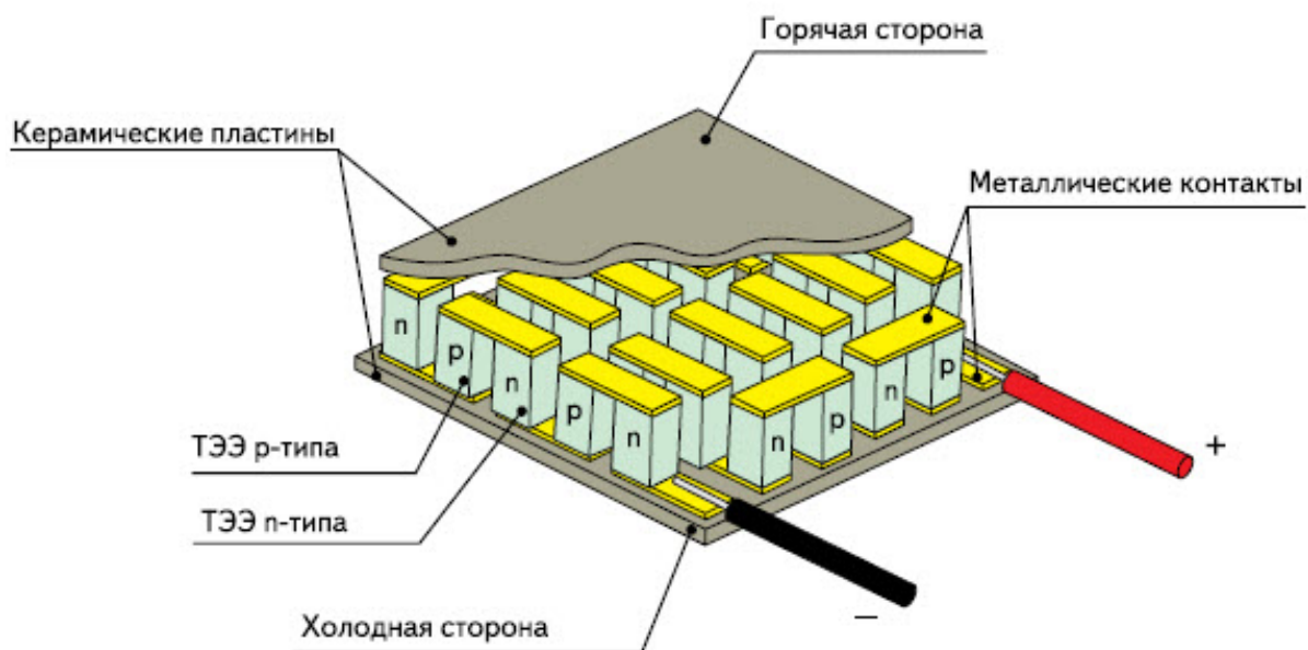
Рис. 3. Устройство термоэлектрического генератора
