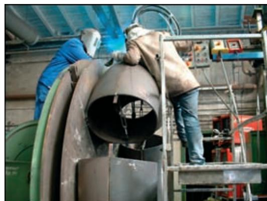
Специалисты «Wolfgang Hoffmeister» считают это одним из наиболее важных преимуществ цифрового TwinTime процесса. В компании «Uhlig» оптимизировали этот процесс с помощью специальной сварочной установки, на которой три трубы диаметром 500...1200 мм с толщиной стенки 20 мм соединяются и прикрепляются заклепками к поворотному диску, а затем привариваются с помощью установки TimeTwin. Медные подкладки обес-
