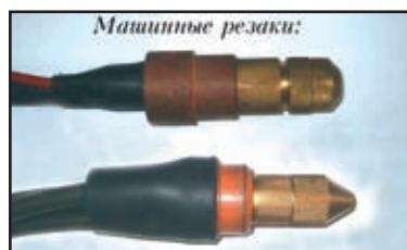
ные резаки с водяным охлаждением на токе до 300 А обладают высоким ресурсом работы катодно-сопловой пары и обеспечиваются устройством, значительно снижающим вредные газопылевые выделения, характерные для резки металлов средних и больших толщин. Все плазменные резаки выполнены с быстросменными катодно-сопловыми узлами. Возможен вариант замены устаревших установок новыми со скидкой в зависимости от состояния заменяемой установки.
