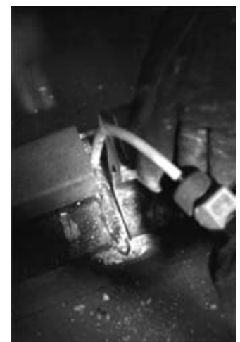
Специальный оптимизированный наконечник сварочной горелки и другие компоненты делают стандартный TransSynergis пригодным для использования при сварке самозащитной порошковой проволокой
