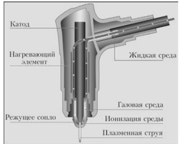
Рис. 2. Жидкость используется в качестве режущей среды в TransCut 300. Она нагревается и ионизируется в газовом резаке. Результат: возможность резать металл толщиной до 10 мм, большая мобильность и меньшее количество выбросов по сравнению с системами резки сжатым воздухом
