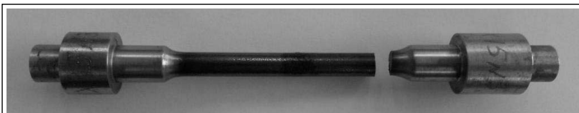
Рис. 3. Образец после испытаний при амплитуде \sigma_a = 260 МПа
