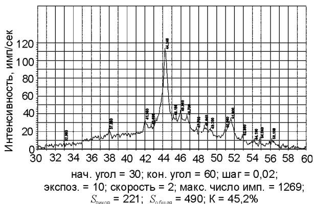
Рис. 12. Фрагменты дифрактограмм, снятых с комбинированного защитного покрытия TiAlN/Ni-Cr (Si, B, Fe) со стороны тонкого покрытия.
