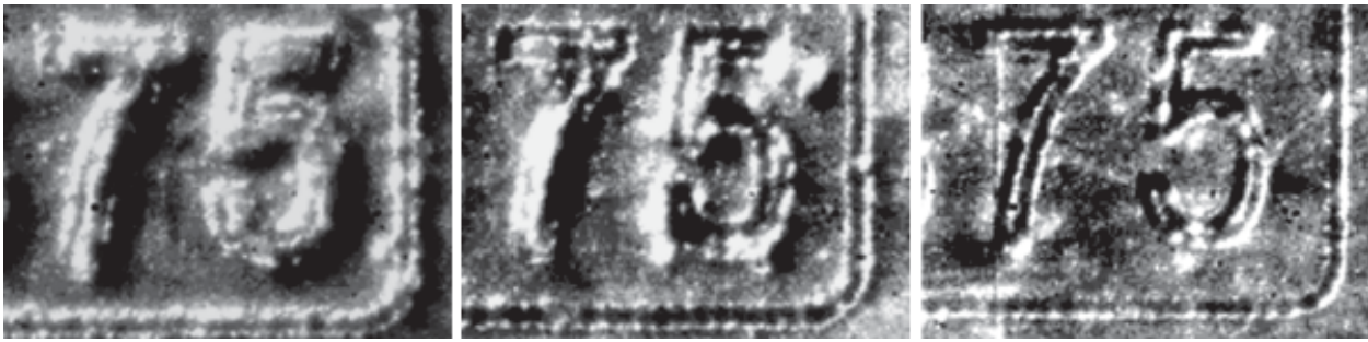
Рис. 1. Примеры выброса металла при лазерной гравировке (ширина линии гравировки 30 мкм).
