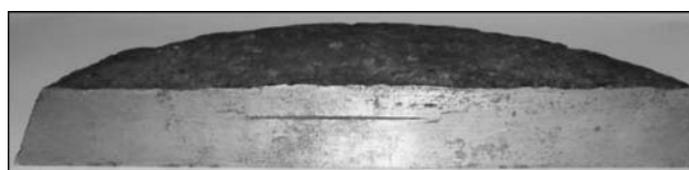
Рис. 5. Образец с сильно корродированной поверхностью с дефектом типа «расслоение», обнаруживаемый ЭМА дефектоскопом
