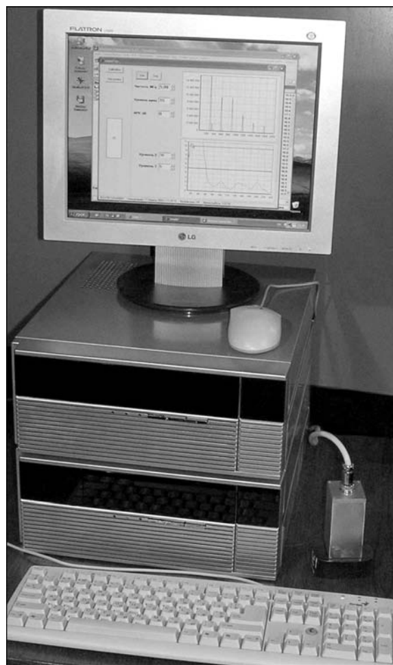
Рис. 3. Двухканальный ЭМА дефектоскоп для ручного и механизированного УЗ контроля сдвиговыми и поверхностными волнами
