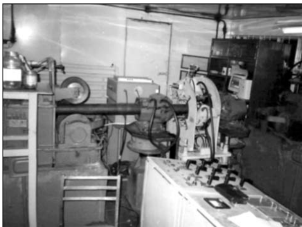
Рис. 2. Автоматический четырехканальный толщиномер ЗАО «НИКО ТЬЮБ» (г. Никополь) (скорость контроля — 1 м/с)
