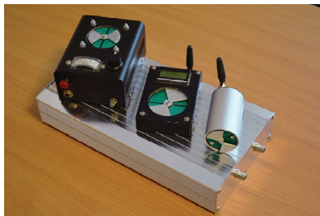
Рис. 5. Апаратурне забезпечення для проведення геоелектричних робіт: на генераторі довгих ліній (алюмінієва коробка) розміщені три модифікації флюксометрів від базової (зліва) до найсучаснішої (справа)
