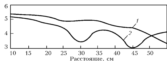
Рис. 1. Ослабление амплитуд волн Рэля с расстоянием в рельсе на различных частотах, МГц: 1 — 0,5; 2 — 0,25
