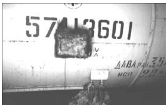
Рис. 2. Установка ПАЭ на цистерну через вырезанные окна в обшивке теплоизоляции
