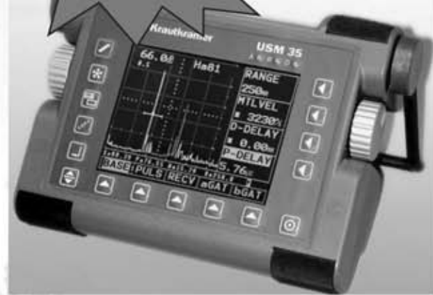
USM 35 — новый портативный ультразвуковой дефектоскоп, пришедший на смену USM 25. В приборе применен современный цветной жидко-кристаллический индикатор с высокой контрастностью, большим углом обзора, беспараллаксной сеткой. Использование цветного индикатора дает оператору дополнительные возможности при проведении контроля
