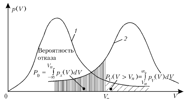
Рис. 1. Выбор гипотезы о ненужном ремонте на основе критерия Неймана–Пирсона; 1 — плотность вероятности вибрации ГПА p_V(V) ; 2 — плотность вероятности отказа P_x(V)
