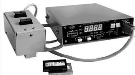
✓ **Коэрцитиметры** – для неразрушающего контроля (по СНГ-стандарту ГОСТ 30415-96) механических свойств, структуры металлопроката, напряженно-деформированного (усталостного) состояния и ресурса конструкций и оборудования из стали и чугуна, контроля режимов термообработки, сортировки по маркам и т.д. Портативные цифровые приборы с сетевым (*КРМ-Ц*) или автономным питанием (*КРМ-Ц-К2М* и *КРМ-Ц-К3*). Микропроцессорный
