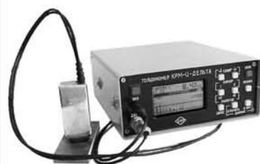
✓ **Бесконтактный толщиномер-дефектоскоп *КРМ-Ц-Дельта*** – ультразвуковой ЭМА-прибор, работает при температурах от -25°C и по горячему металлу в несколько сот градусов, без контактной жидкости, без специальной зачистки поверхности, по краске или через воздушный зазор около 1 мм, с погрешностью не более 0,1 мм, с отображением на экране зондирующего и донных импульсов, с запоминанием всех эхограмм и передачей их по каналу связи в ПЭВМ для документирования результатов контроля.
