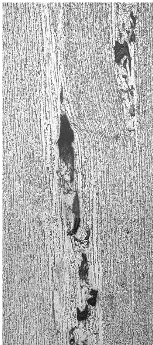
Рис. 1. Слоисто-водородное растрескивание в зоне Б (×100)
