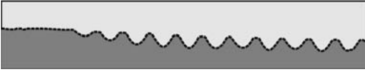
Рис. 3. Профіль конусної трубної різьби і його контур
