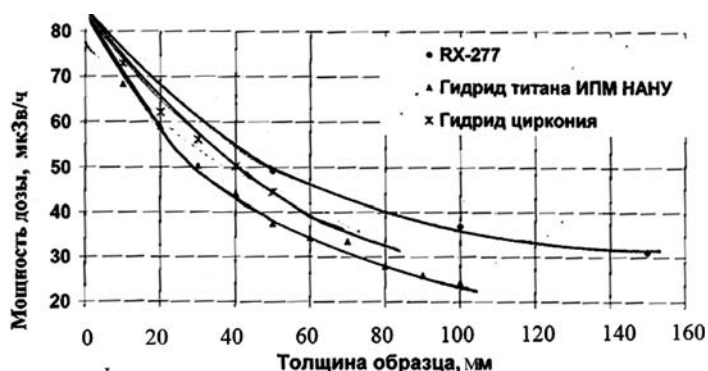
Рис. 2. Зависимость мощности дозы облучения от толщины образцов при облучении на Pu-Be источнике нейтронов
