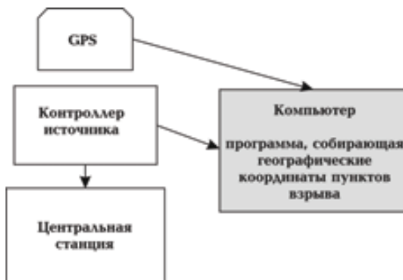
Рис. 1. Блок-схема системы определения местоположения пунктов возбуждения упругих колебаний.
