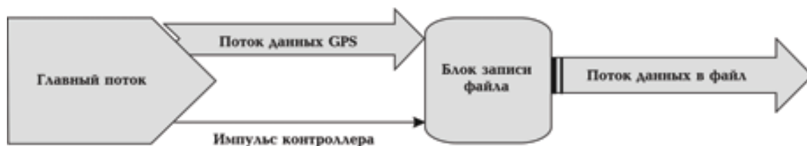
Рис. 2. Алгоритм программы сбора географических координат пунктов возбуждения упругих колебаний.
