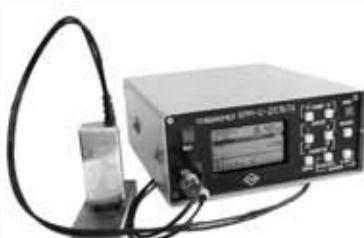
✓ **Бесконтактный толщиномер-дефектоскоп KRM-Ц-Дельта** – ультразвуковой ЭМА-прибор, работает при температурах от -25°C и по горячему металлу в несколько сот градусов, без контактной жидкости, без специальной зачистки поверхности, по краске или через воздушный зазор около 1 мм, с погрешностью не более 0,1 мм, с отображением на экране зондирующего и донных импульсов, с запоминанием всех эхограмм и передачей их по каналу связи в ПЭВМ для документирования результатов контроля.
