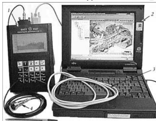
Рис. 4. Простейшая переносная система диагностики вращающегося оборудования производства АО ВАСТ: 1 — сборщик данных — анализатор СД-12; 2 — персональный компьютер типа Notebook; 3 — интерфейсный кабель для обеспечения связи между анализатором и компьютером; 4 — датчик вибрации
