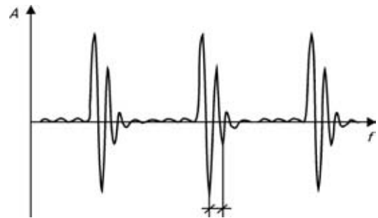
Рис. 5. Осциллограмма подшипника при его диагностировании методом ударных импульсов
