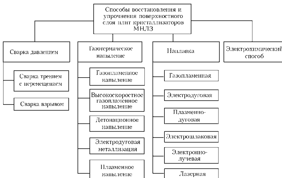
Рис. 7. Способы восстановления и упрочнения поверхностного слоя плит кристаллизаторов МНЛЗ
