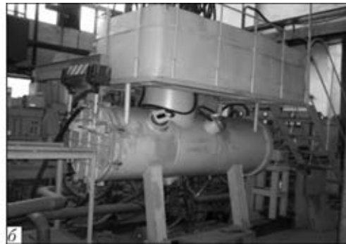
Рис. 8. Плазменно-дуговая установка ОБ-1957: а — схема; б — внешний вид; 1 — обрабатываемая заготовка; 2 — кристаллизатор; 3 — ванна жидкого металла; 4 — плазмотроны
