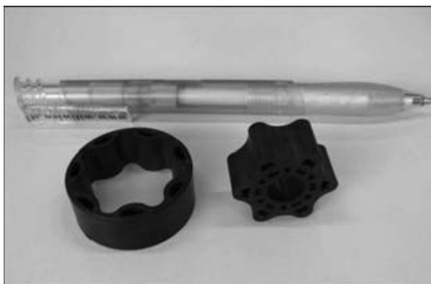
Рис. 7. Изделия, изготовленные с помощью пресс-форм из пластмассы, упрочненной углеродными волокнами
