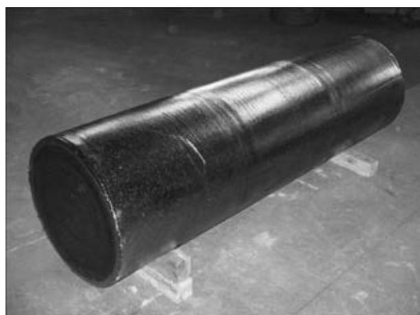
Рис. 1. Оплавленный слиток диаметром 600 мм титанового сплава BT14
