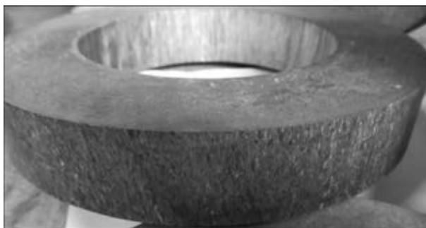
Рис. 8. Макроструктура трубной заготовки из титанового сплава ВТ14 диаметром 190/90 мм
