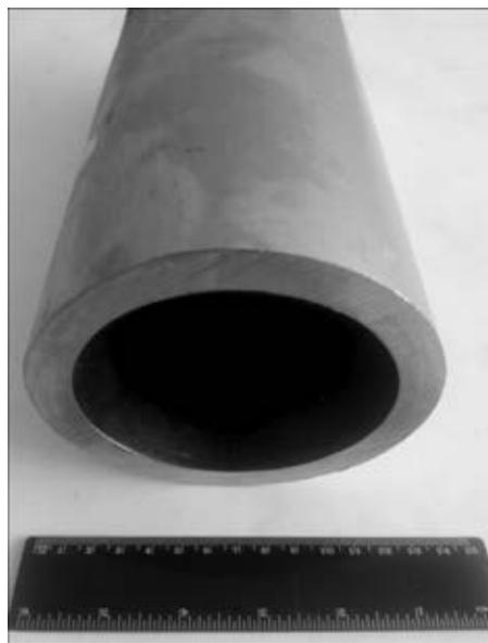
Рис. 9. Труба горячепрессованная диаметром 120×15×2500 мм после механической обработки
