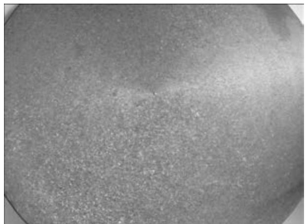
Рис. 5. Макроструктура ковanej прутка из титанового сплава ВТ14 диаметром 200 мм
