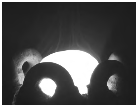
Рис. 4. Плавка кремния при ИПСК в разреженной атмосфере
