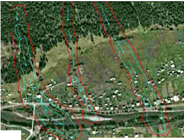
Рис. 1. Схема расположения зон фильтрационных водных потоков на участке “Верховина”, Ивано-Франковская обл., на спутниковом снимке местности (по результатам обработки и интерпретации данных ДЗЗ). Стрелками показано направление фильтрации водных потоков
