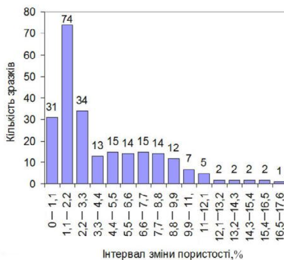
Рис. 1. Гістограма розподілу відкритої пористості карбонатних зразків керна порід карбону св. 14, 26, 27, 29, 33, 36, 42, 43, 45, 46 Гнатівської площі
