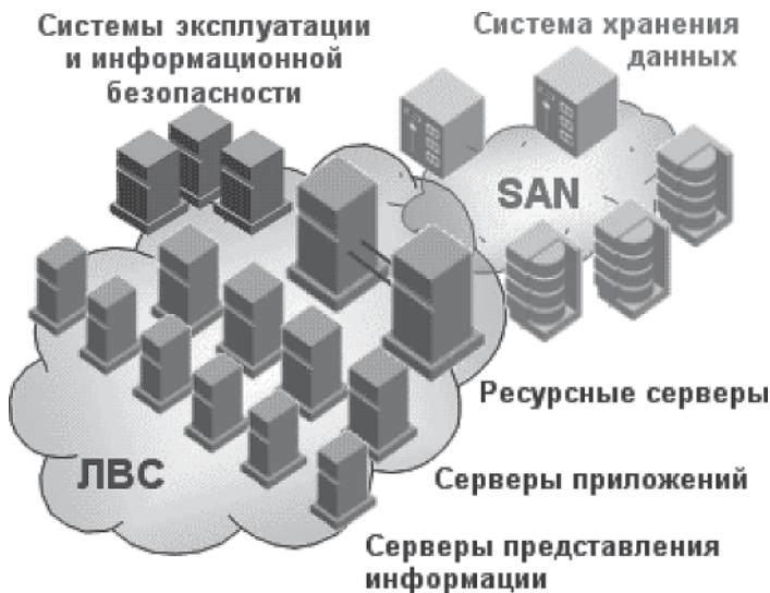
Рис. 2. Общая структура центра обработки данных
