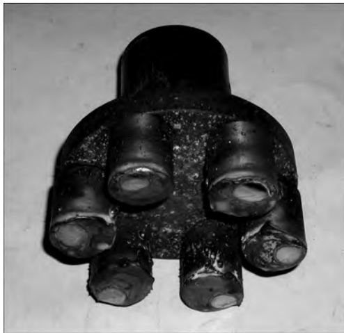
Рис. 2. Внешний вид расходимого электрода после плавки
