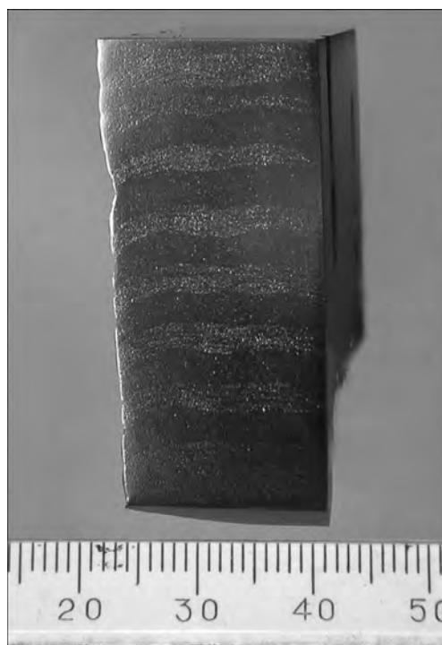
Рис. 2. Макроструктура поперечного сечения монокристалла вольфрама (110)
