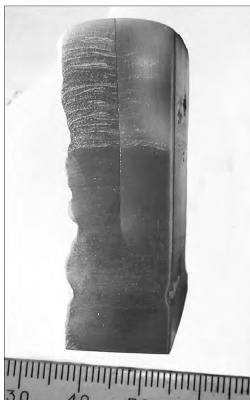
Рис. 4. Макроструктура поперечного сечения монокристалла вольфрама (110)
