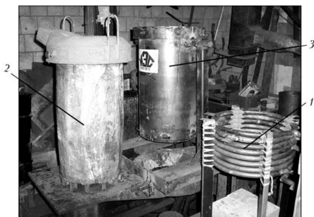
Рис. 2. Общий вид плавильно-разливочного модуля: 1 — индуктор; 2 — ковш; 3 — разливочный модуль
