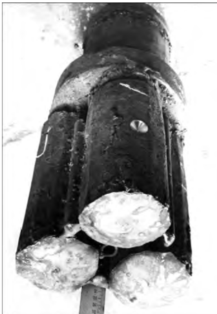
Рис. 5. Торец составного электрода диаметром 65 мм, полученного способом взрыва после плавки в режиме ДШП
