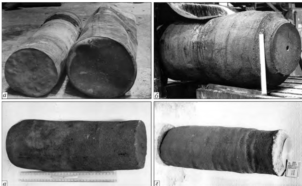
Рис. 3. Электроды длиной 1450 мм, диаметром 400 мм ( a , б ) и длиной 380 мм, диаметром 150 мм ( в , г ), полученные способом изостатического прессования: a – губка ТГ-ТВ; б – губка ТГ-120; в – губка ТГ-ТВ; г – губка ТГ-120
