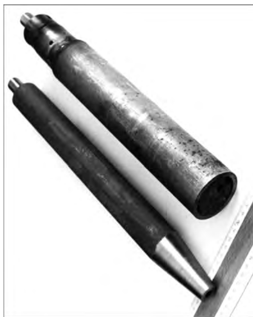
Рис. 1. Электроды из губчатого титана, полученные способом холодного прессования в матрице
