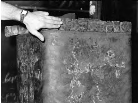
Рис. 4. Слиток из титана, выплавленный способом ДШП в кристаллизатор 365 мм
