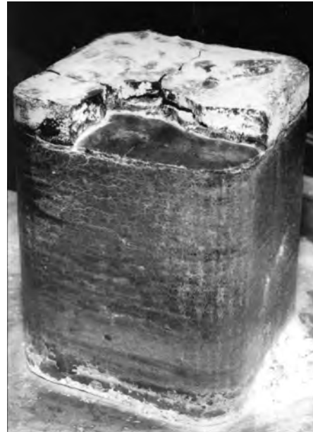
Рис. 6. Слиток из титана, выплавленный способом ДШП в кристаллизатор 200 мм
