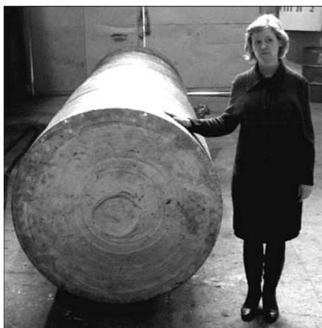
Рис. 5. Слиток диаметром 1100 мм
