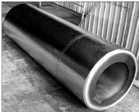
Рис. 10. Трубная заготовка размерами 600/400x2000 мм
