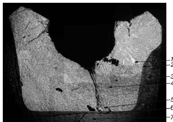
Рис. 3. Поперечный разрез образца (X16) при температуре опыта 2100 °C: 1 — 2,9; 2 — 15,0; 3 — 18,0; 4 — 4,6; 5 — 13,0; 6 — 13,4; 7 — 19,9 мас. % N
