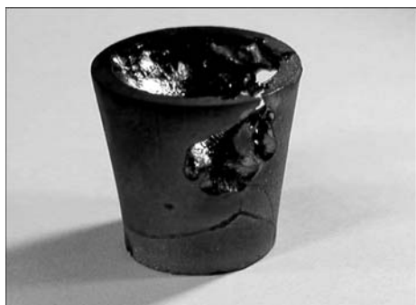
Рис. 2. Общий вид тигля после плавки
