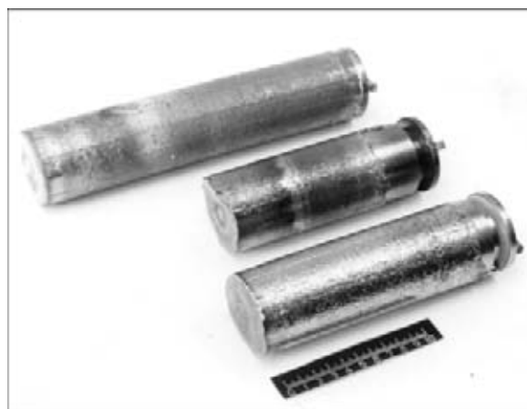
Рис. 2. Слитки ИПСК, выплавленные из отходов гранулированных порошков сплава ВТ5-1 кг
