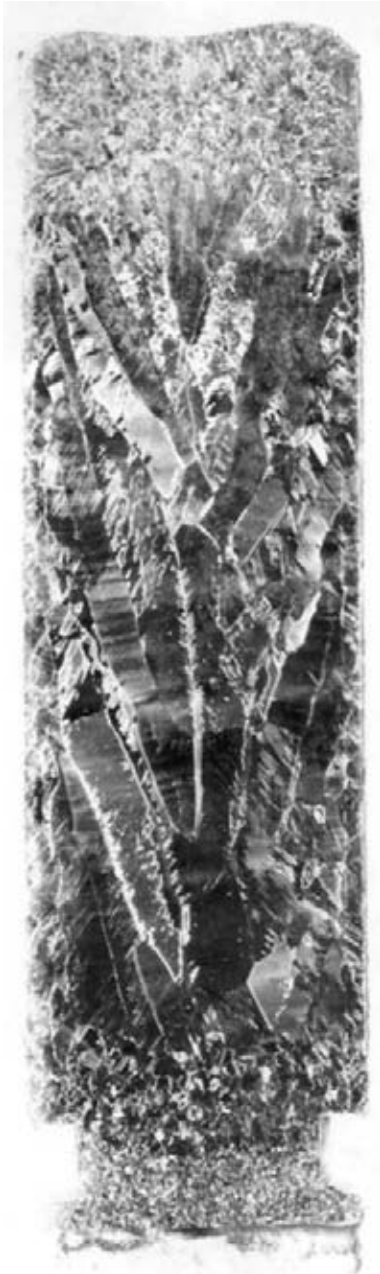
Рис. 3. Макроструктура слитка ИПСК сплава BT5-1 кт
