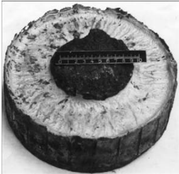
Рис. 10. Внешний вид полого слитка-заготовки (типа шайбы) диаметром 220 мм с графитовым стержнем
