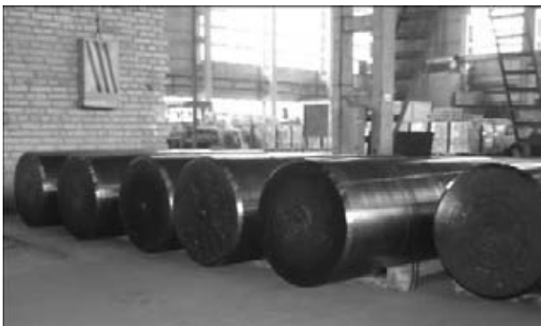
Рис. 1. Слитки из титана марки Grade 2
