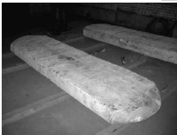
Рис. 4. Кованые слябы из титана марки Grade 2
