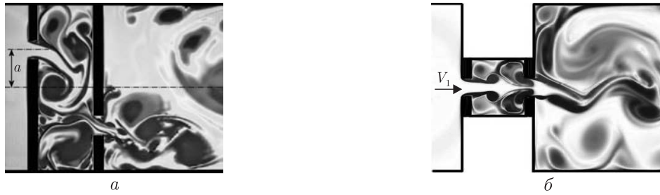
Рис. 4. Поле завихренности течения: a — при a/D_1 = 0,25 ; б — D_4/D_1 = 0,33 (остальные параметры такие же, как на рис. 3, a )
