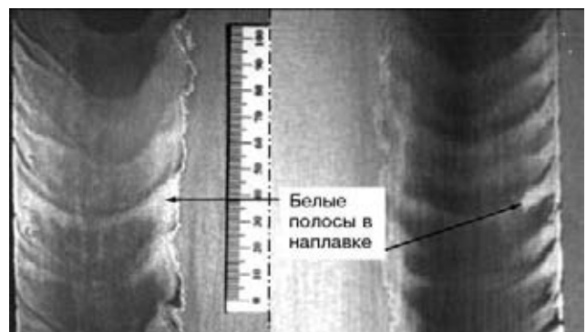
Рис. 4. Белые полосы в макроструктуре наплавки
