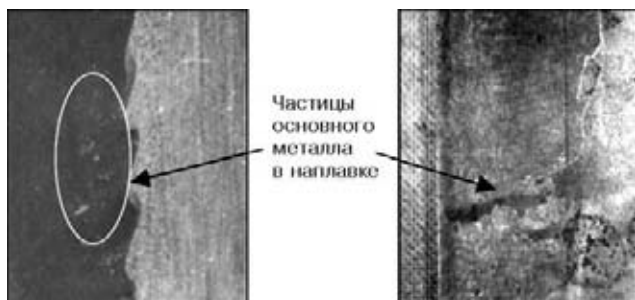
Рис. 6. «Капли» основного металла в наплавленном слое
