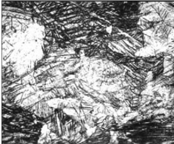
Рис. 3. Микроструктура (X100) горячекатаных труб
