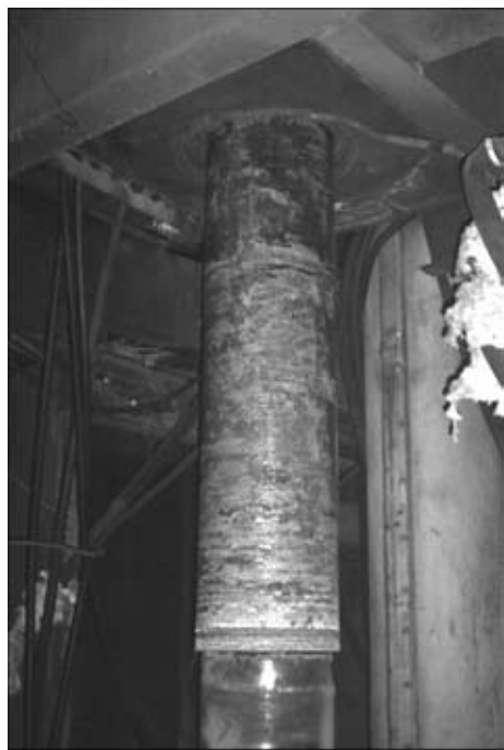
Рис. 5. Биметаллический слиток диаметром 350 мм после электрошлаковой наплавки методом ЭШП ЖМ коррозионностойкого аустенитного слоя толщиной 35 мм
