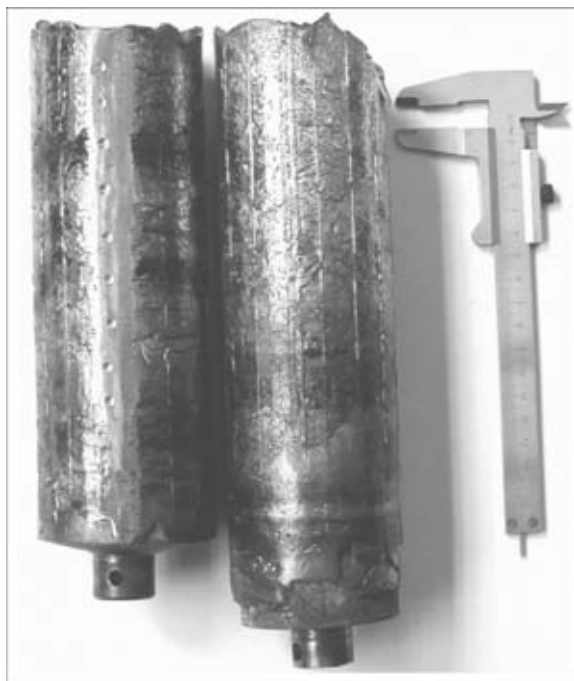
Рис. 7. Слитки ИПСК, выплавленные из газонасыщенного губчатого титана
