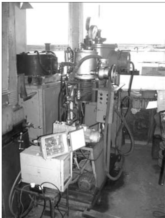
Рис. 1. Общий вид индукционной установки для переплава губчатого титана в индукционном кристаллизаторе с измерительным приборным блоком
