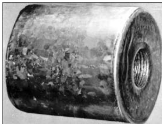
Рис. 5. Внешний вид полого слитка после оплавления
