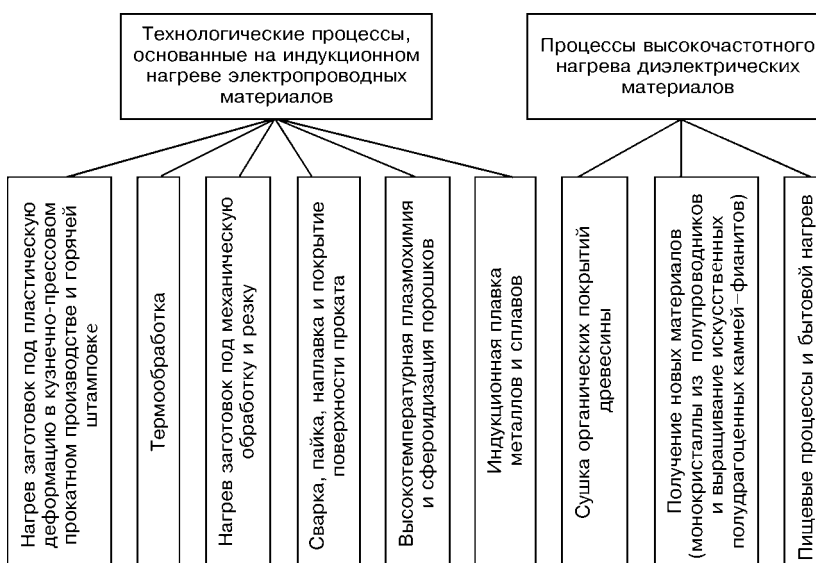
Рис. 1. Классификация процессов и установок, использующих индукционный нагрев
